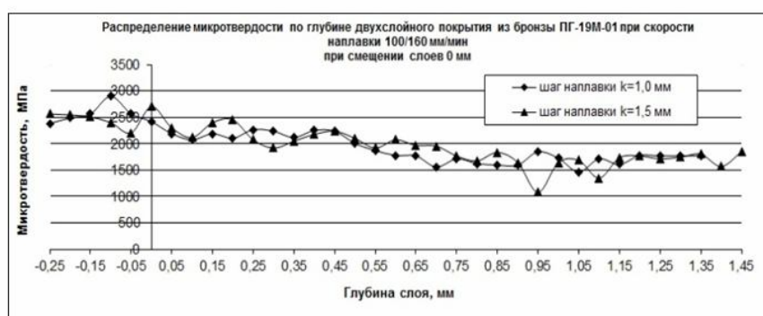
Рис. 3. Распределение микротвердости по глубине двухслойного покрытия из бронзы ПГ-19М-01 при скорости наплавки V = 100/160 мм/мин
